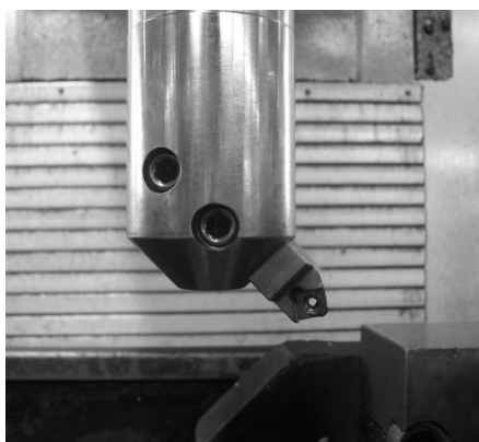
图3 铣刀尖到铣刀杆中心线的距离
